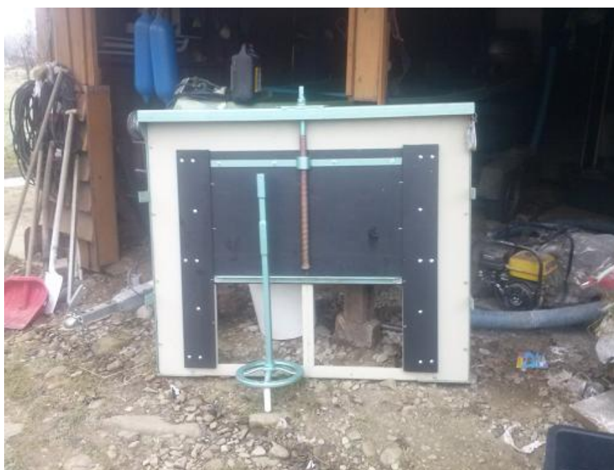
Stawidło na OZ Zawada przed zamontowaniem
